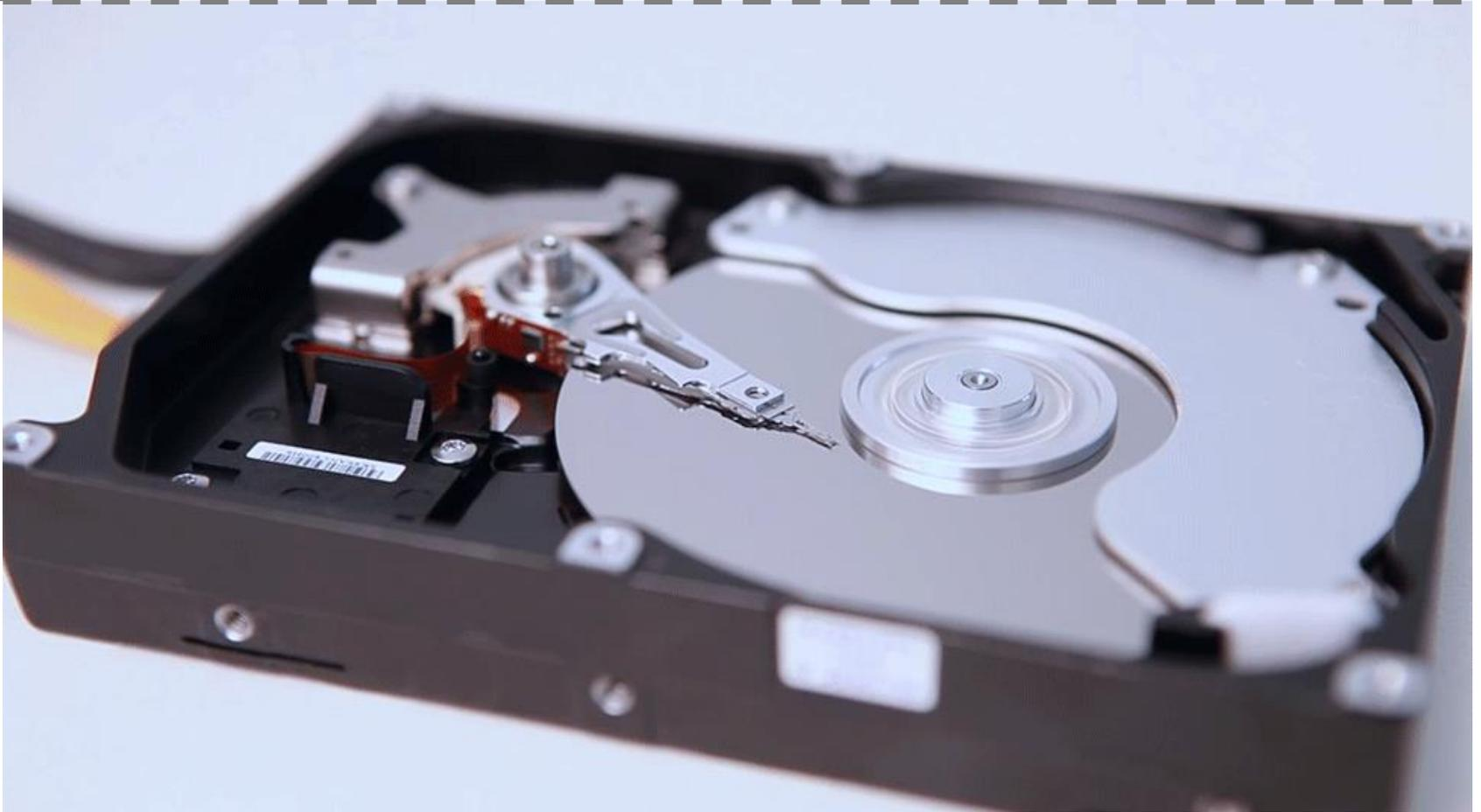
*Tiene un brazo mecánico que tiene que moverse para cambiar el bloque*
